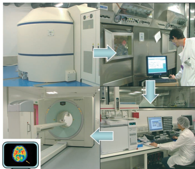
Abbildung 2. Der Weg eines PET-Radiotracers vom Zyklotron zum PET-Scanner („Bench-to bedside“). Beginnend links oben: kommerziell erhältliches biomedizinisches Zyklotron; automatisiertes Radiomarkierungssystem, das von außerhalb der heißen Zelle bedient wird; Analytik- und Qualitätskontrolllabor; kombinierter PET/CT-Scanner (Siemens) mit fertigem PET-Bild. Der gesamte Vorgang dauert einige Stunden.
